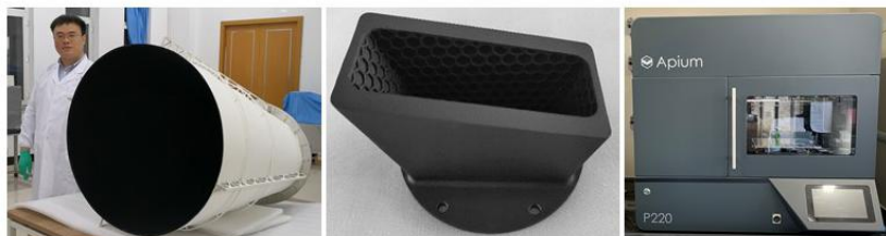
自主开发超黑涂层材料，经3D打印等技术生产出卫星用遮光罩产品
