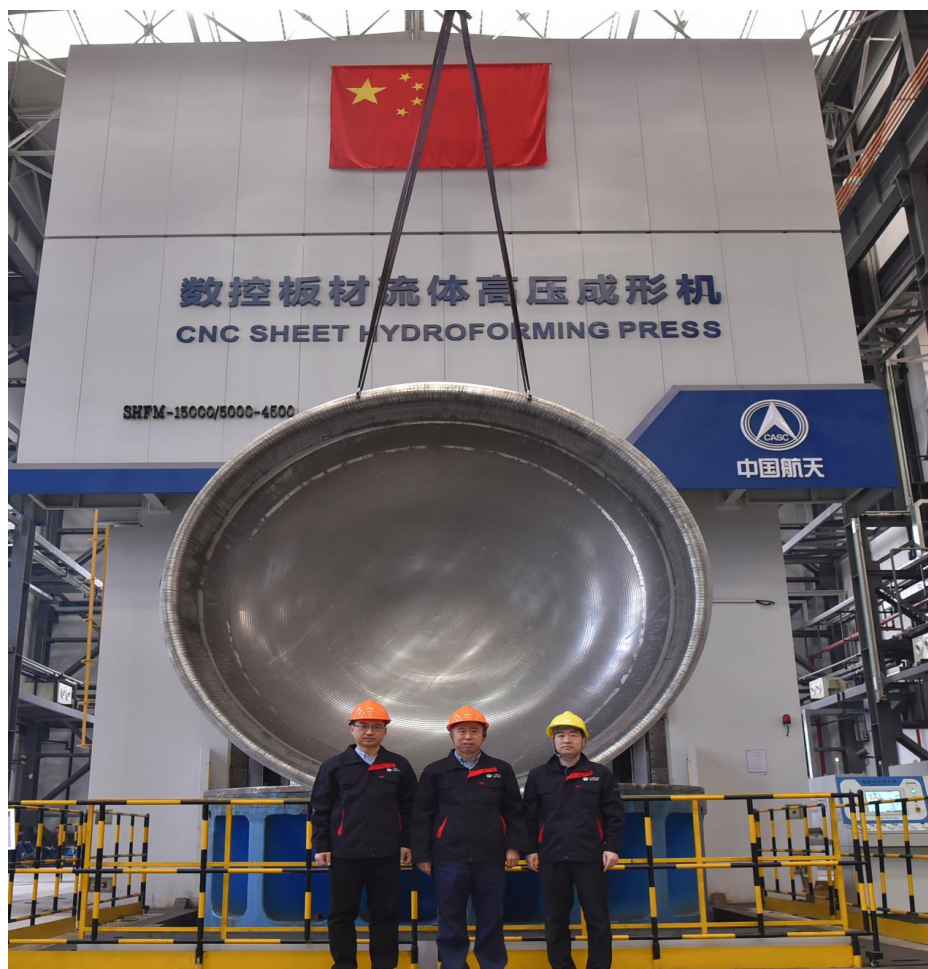
图 1: 苑世剑教授团队研发的世界最大数控板材流体高压成形机 及世界首个 3 米级整体火箭贮箱底
