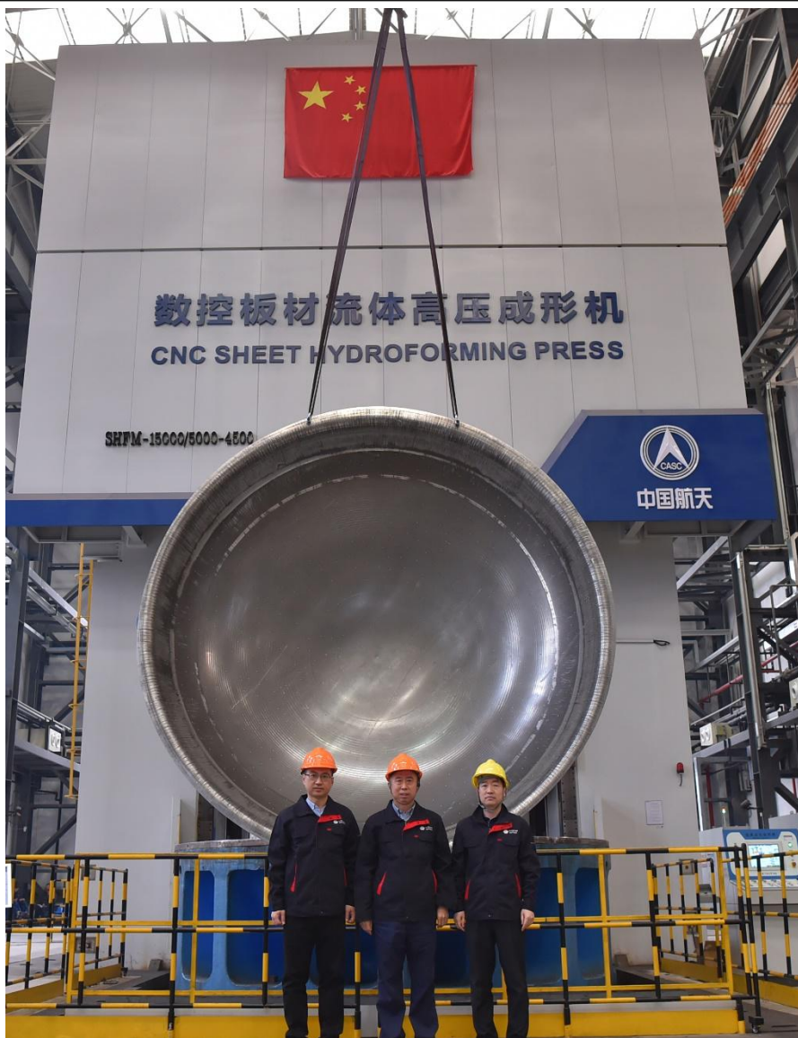
图 1: 苑世剑教授团队研发的世界最大数控板材流体高压成形机 及世界首个 3 米级整体火箭贮箱底
